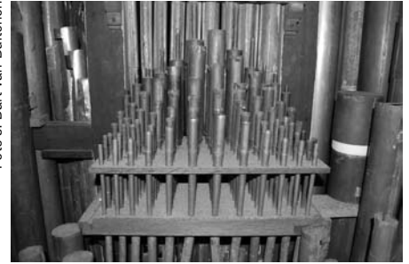
Pijpwerk Cornet, cis-zijde.
